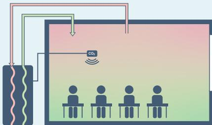
**Apparecchio di ventilazione centralizzato**
