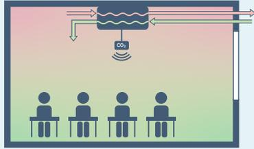
**Singoli apparecchi di ventilazione decentralizzati: apparecchi a soffitto, a muro o mobili**
